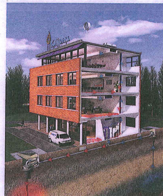
De werking van een wko-installatie in de zomer: koude lucht gaat het gebouw in.
